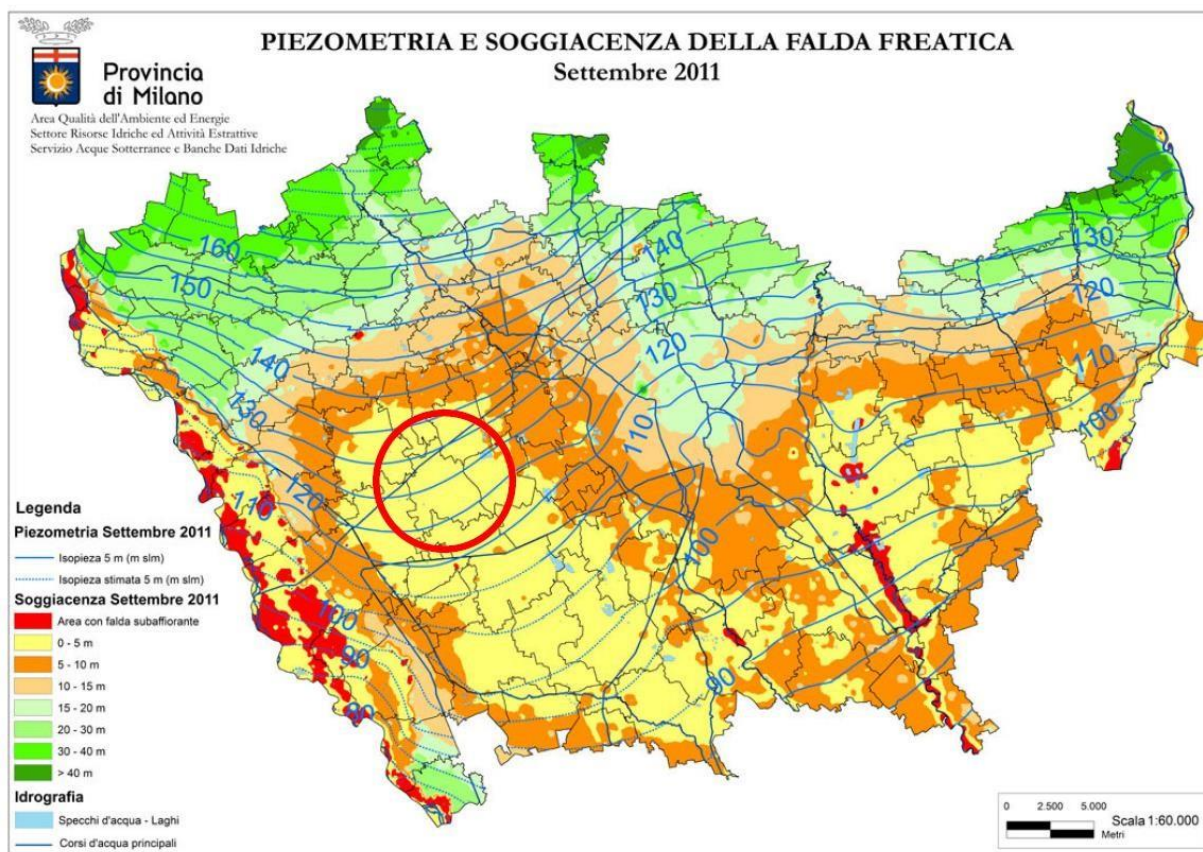
Figura 4-4 – Inquadramento piezometrico area di intervento (Piezometria e soggiacenza della falda freatica, settembre 2011, provincia di Milano)
